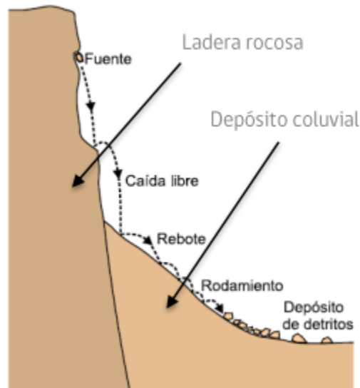
FIG. 4. Esquema típico del proceso de caída de rocas (Modificado de Proyecto Multinacional Andino, 2007).
