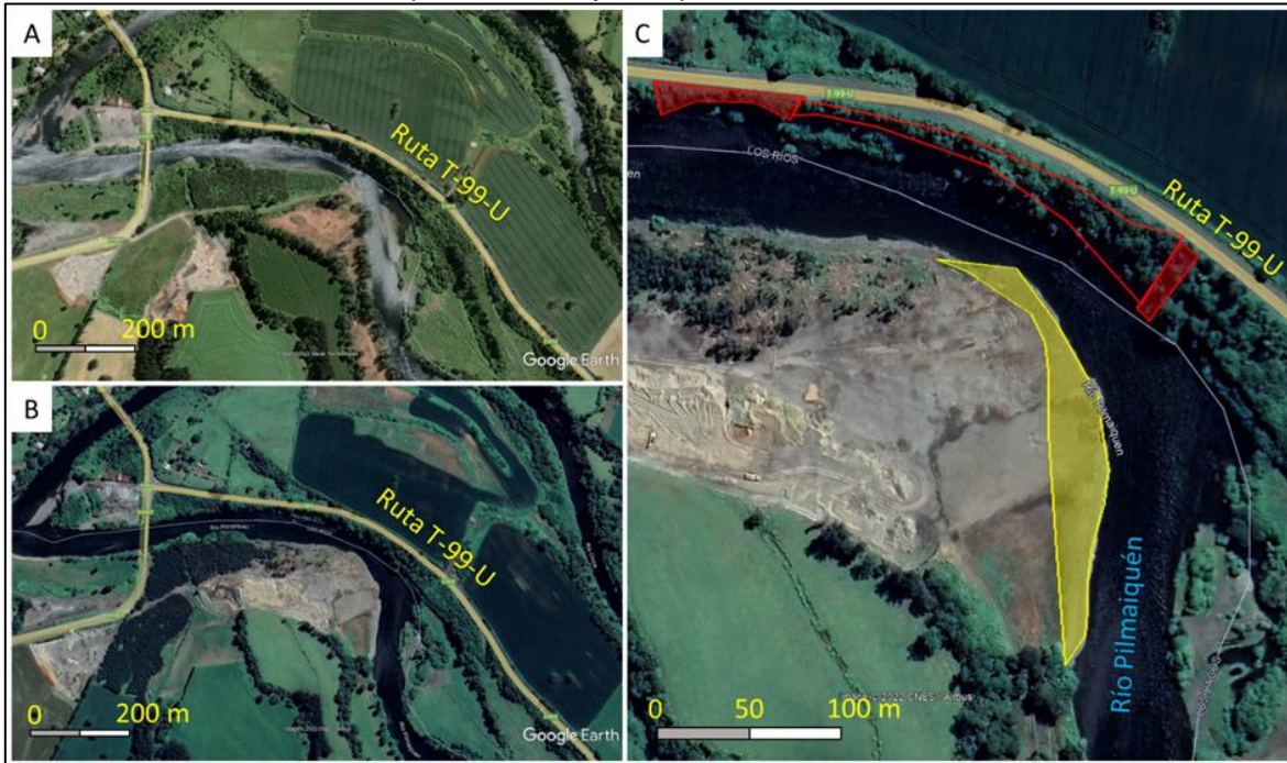
Figura 3. Comparación de imágenes satelitales entre 2016 y 2022. A. Meandro del río Pilmaiquén en 2016. B. Meandro del río Pilmaiquén en 2022, destaca la extracción de áridos en la ribera izquierda del río. C. En el polígono amarillo se indica la extensión del relleno con áridos en la ribera izquierda del río Pilmaiquén existente en 2022 que cubre un área aproximada de 4.600 m 2 ; los polígonos en borde rojo indican zonas de alta pendiente e inestables en la ribera derecha del río; polígonos rellenos en rojo además indican zonas con evidencias de remociones en masa (erosión) reciente.
