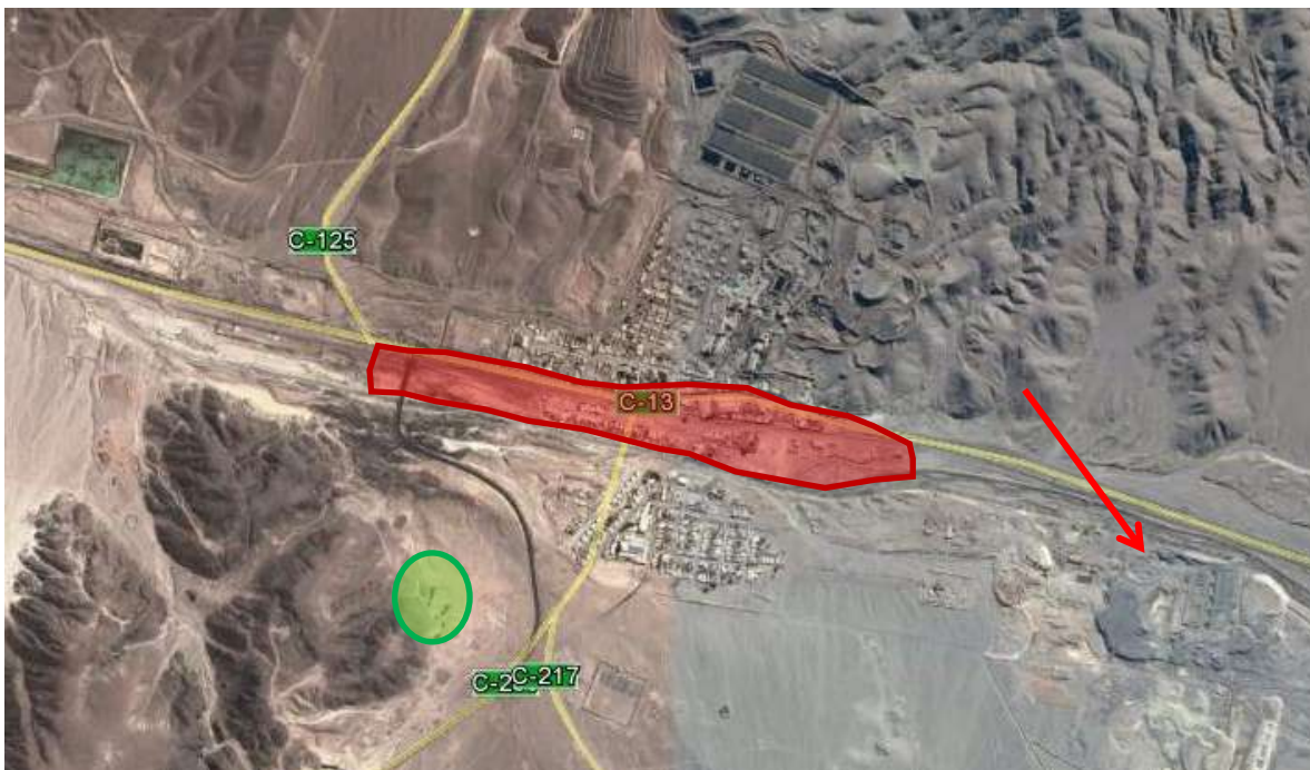
Fig. 2. Zonas afectadas en localidad de El Salado. En rojo la zona arrasada por flujos de detritos. En color verde sector de campamento improvisado. La flecha roja indica la ubicación de relaves socavados en su base por la escorrentía del flujo.
