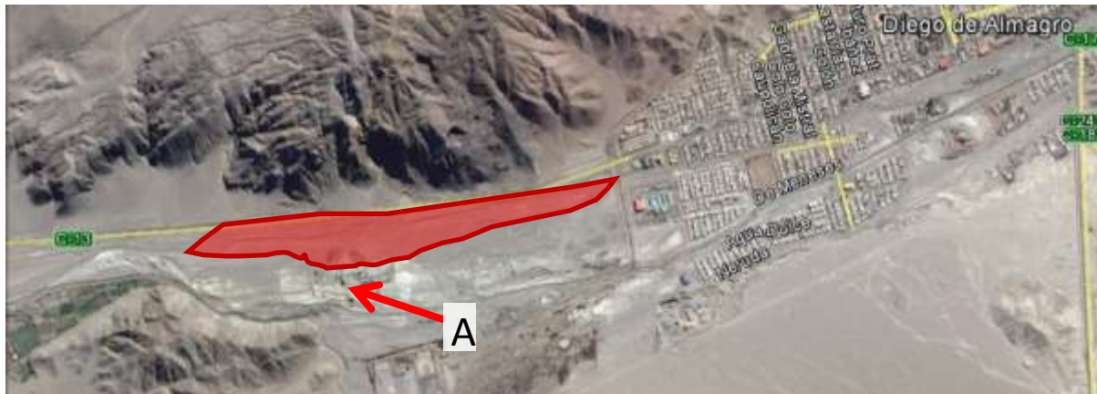
Fig. 7a. Zona en rojo, nuevo cauce socavado durante aluvión. Flecha roja indica la ubicación de una planta de procesos y acopio mineral.
